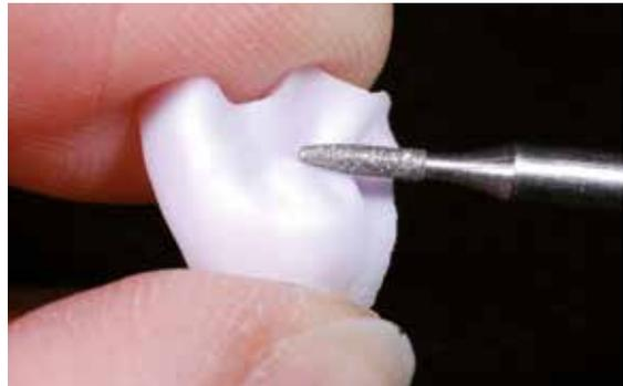
Insbesondere funktionelle Bereiche mit einem feinkörnigen Diamanten überschleifen, um das CAD/CAM-bedingte Oberflächenrelief zu glätten.
