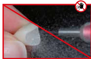
Rückstände **nicht** mit  $\text{Al}_2\text{O}_3$  oder Glanzstrahlperlen ab-
