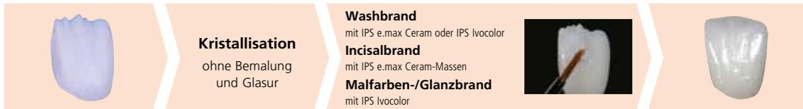
Kristallisation ohne Auftrag von Massen. Incisalbrand mit IPS e.max Ceram-Massen. Malfarben-/Glanzbrand mit IPS Ivocolor-Massen.
