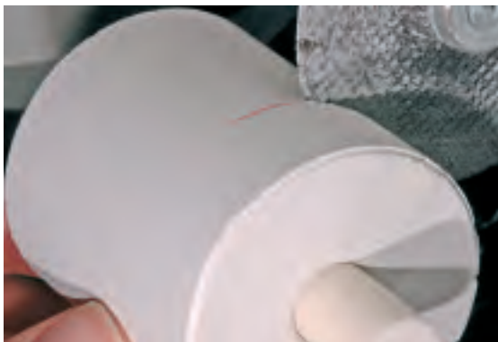
Séparer le cylindre à l'aide d'un disque à tronçonner et le rompre au niveau du repère.
