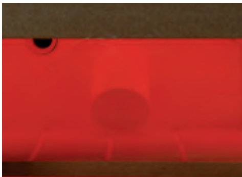
Placer le cylindre dans le four, l'ouverture tournée vers le bas
