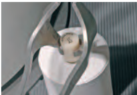
Introducir la pastilla fría de IPS e.max en el cilindro de revestimiento caliente con la marca de color hacia arriba
