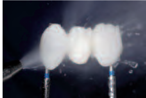
Antes de proceder al recubrimiento de la estructura, arenarse con Al 2 O 3 y 1 bar presión y lavar con agua corriente o con vapor
