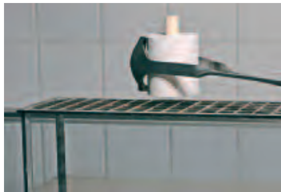
Una vez finalizado el programa de inyección, colocar el cilindro caliente utilizando las pinzas para cilindros sobre la rejilla de enfriamiento y dejar enfriar a temperatura ambiente
