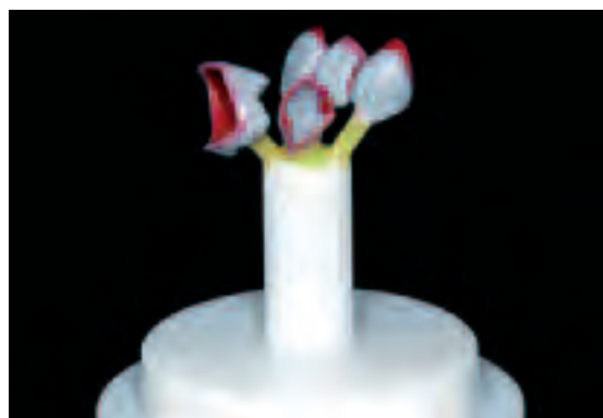
La colocación de jitos se lleva a cabo en la base del cilindro de revestimiento de IPS e.max. Los jitos deben colocarse en la dirección de flujo de la cerámica y siempre en la parte más gruesa de las restauraciones
