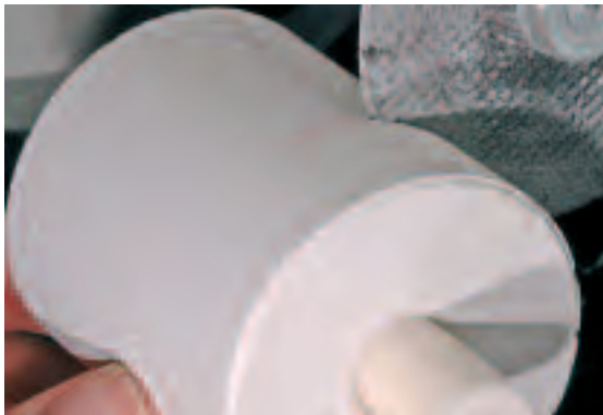
Cortar el cilindro con un disco y separar en dos por la zona cortada
