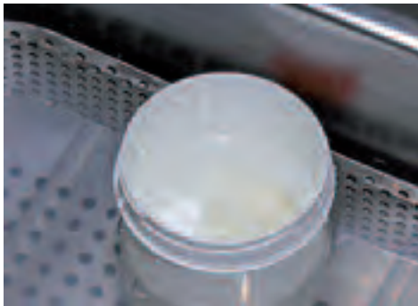
Eliminar la capa de reacción de las piezas inyectadas con líquido Invex en baño de ultrasonido
