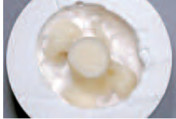
La eliminación gruesa del revestimiento se realiza con perlas de brillo a 4 bar de presión hasta hacer visible la pieza inyectada
