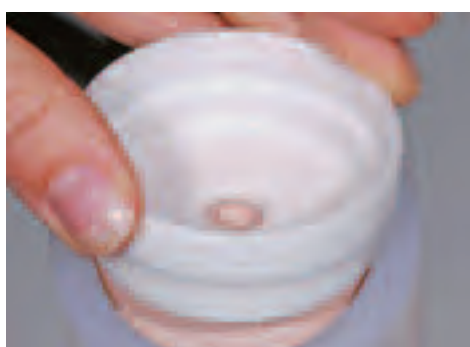
Llenar el cilindro hasta la marca y ajustar la guía del cilindro mediante un movimiento basculante
