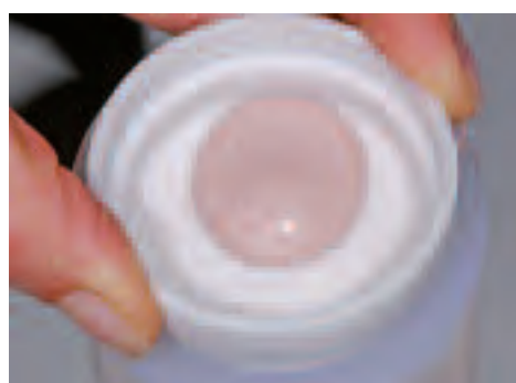
Llenar el cilindro hasta la marca y ajustar la guía del cilindro mediante un movimiento basculante
