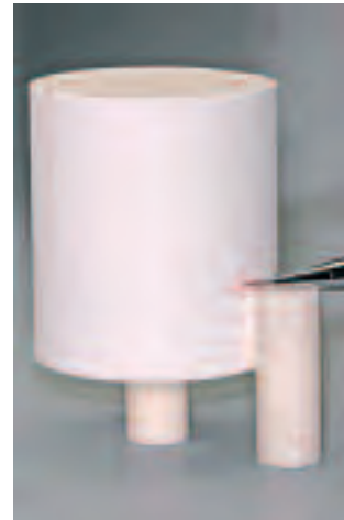
Marcar la longitud del pistón AlOx
