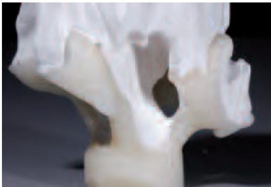
La eliminación definitiva del revestimiento se efectúa con perlas de brillo a 2 bar de presión
