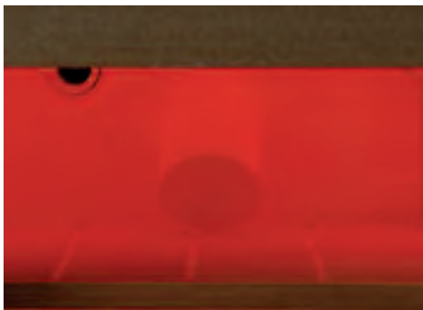
Colocar el cilindro de revestimiento en la parte posterior de la cámara, inclinado con el canal de inyección hacia abajo
