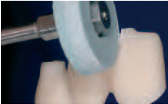
Repasar los puntos de inserción de los canales de inyección a baja revolución y reducida presión
