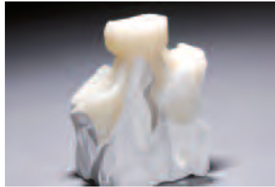
La eliminación definitiva del revestimiento se efectúa con perlas de brillo a 2 bar de presión
