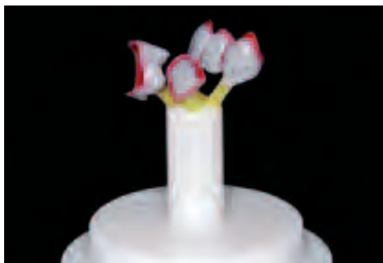
Enecerado y colocación de jitos completada en el cilindro de 200g del sistema IPS e.max
